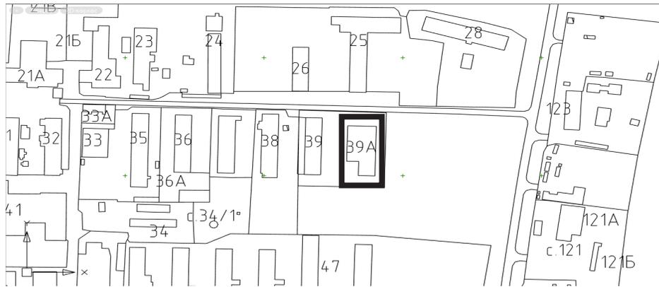
□ - планируемое к строительству здание по производству кирпичных изделий № 39А
