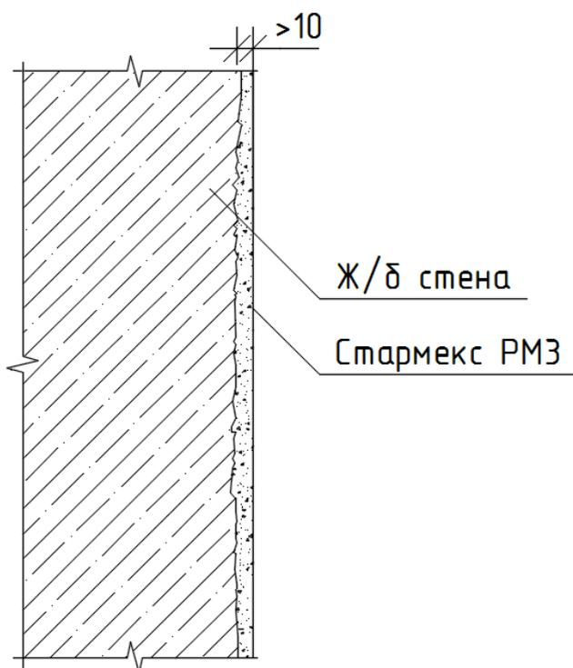
Рис.1 Восстановление защитного слоя железобетонных элементов с глубиной повреждения более 10 мм.
